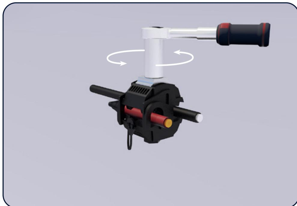
Se utiliza una llave de vaso hexagonal de 13 mm para apretar la tuerca. Se comprueba que los cables continúan rectos en el conector de perforación.
