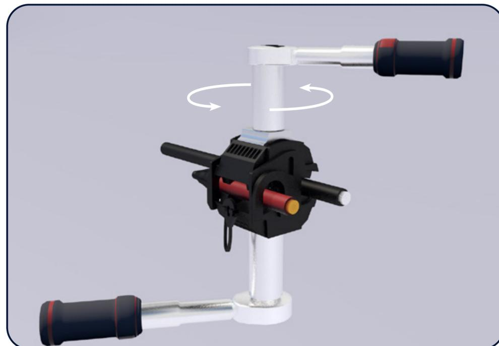
Se utiliza una llave de vaso hexagonal de 15 mm en la parte inferior del conector de perforación, como soporte, para el correcto apriete de la tuerca.
